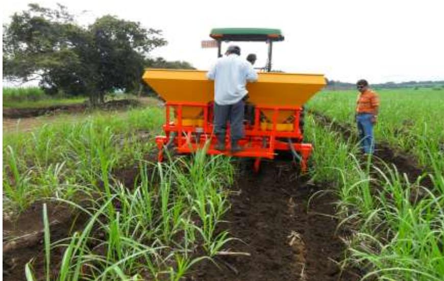
Figura 15. Abonadora aplicando fertilizante en una plantación de caña de azúcar.
