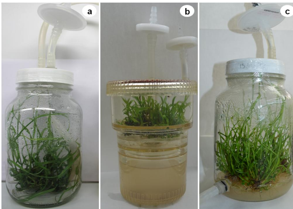
Figura 1. Sistemas de Inmersión Temporal. a) Biorreactor de Inmersión Temporal (BIT), b) Recipiente de Inmersión Temporal Automatizado (RITA) y c) Biorreactor de inmersión por gravedad (BIG).
